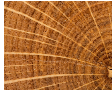
Abb. 10: Holzstrahlen im Querschnitt von Eichenholz.
