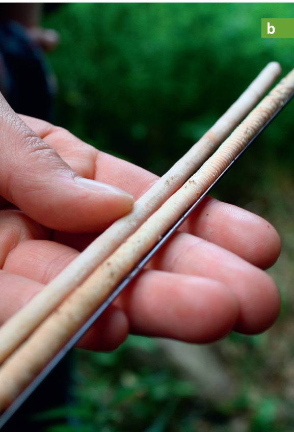
Abb. 21: [a] Einsatz des Zuwachsbohrers, [b] aus dem Zuwachsbohrer entnommener Bohrkern.
