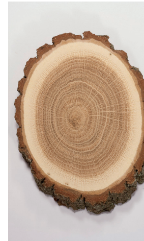
Abb. 5: Stammquerschnitt von Eiche mit dunklem Kernholz und hellem Splintholz.
