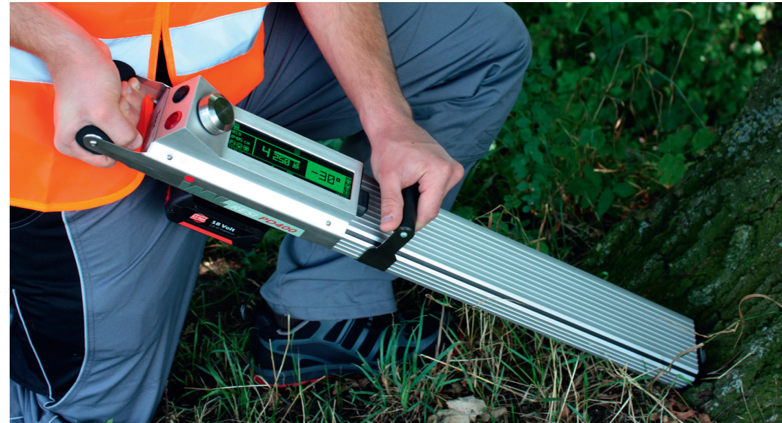
Abb. 26: Einsatz eines Resistographen.
