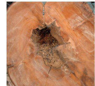
Abb. 6: Buchenstammholz mit Kernfäule und Überwallungswulsten (oben).
