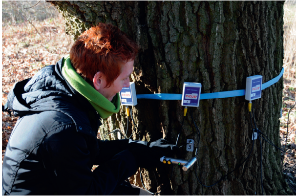
Abb. 28: Einsatz eines Schalltomographen.
